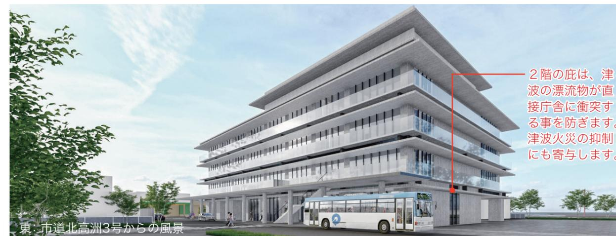
2階の庇は、津波の漂流物が直接庁舎に衝突する事を防ぎます。津波火災の抑制にも寄与します。
