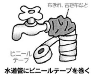
水道管にビニールテープを巻く
