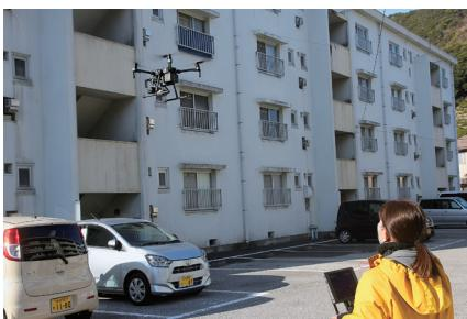
1月18日、千怒市営アパートの外壁・屋上点検をドローンによる空撮を用いて実施しました。
